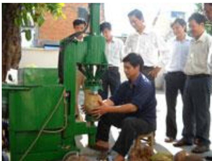
Hình 14. Thử nghiệm máy lột vỏ dừa ở tỉnh Bến Tre
