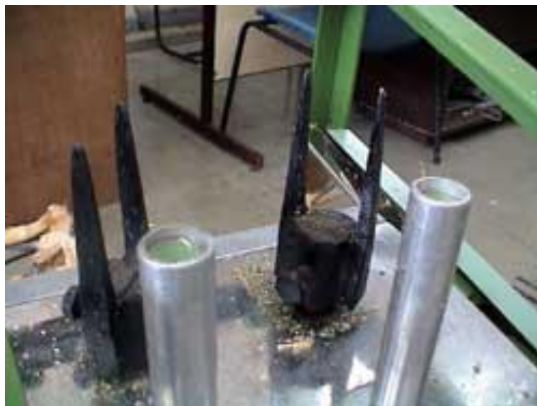
Hình 9. Vỏ dứa được tách bởi hai trục nhọn xoay tròn
