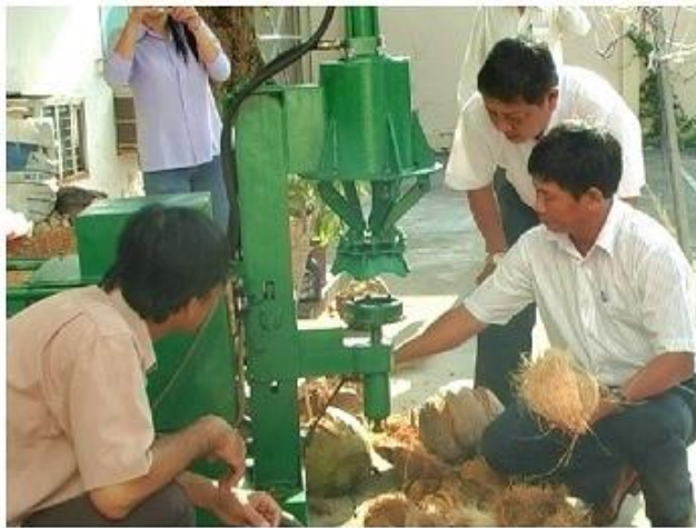
Hình 6. Máy tách vỏ bằng phương pháp tách bung một lần và quả dừa sau khi tách
