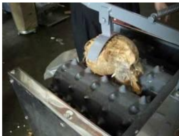
Hình 8. Cơ cấu trục tách răng nhọn
