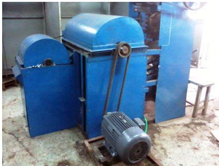
Hình 44. Mẫu máy tách đập vỏ tước chỉ xơ liên hoàn
