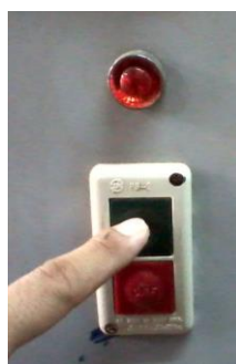
Hình 41. Nhấn mở máy trực đập ép
