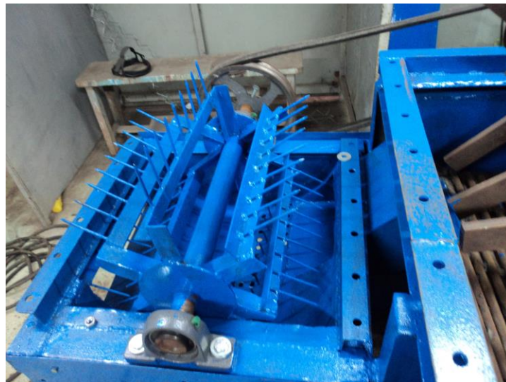
Hình 38. Cụm lược chỉ xơ và mụn dừa của máy
