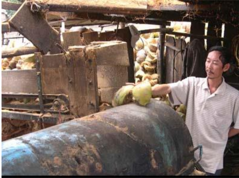
Hình 16. Anh Nguyễn Ngọc Sơn bên máy tước chỉ xơ dừa cải tiến
