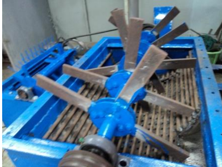
Hình 37. Cụm đập ép vỏ của máy
