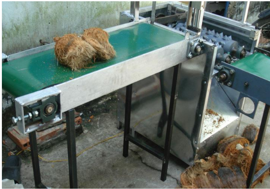
Hình 15. Máy lột vỏ dừa của sinh viên ĐH Kỹ thuật Công Nghệ.Tp HCM
