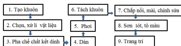
Biểu đồ: Mô hình hóa quy trình chế tác mào, mặt nạ của người Khmer.
